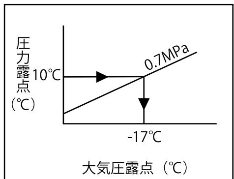
圧力0.7MPa、圧力露点10°Cを大気圧露点に換算しますと-17°Cになります。
