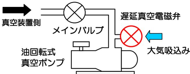
\*真空ポンプと遅延真空電磁弁は連動させて使用します。
